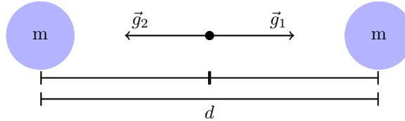
Sin embargo, el potencial gravitatorio en ese punto no es necesariamente nulo, ya que el potencial es una cantidad escalar y se suma algebraicamente. Por el principio de superposición:
